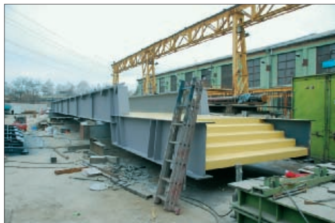
11. kép: Gyártási-szállítási-beemelési egység: a vasút felett áthidaló alsópályás gerendaszerkezet
